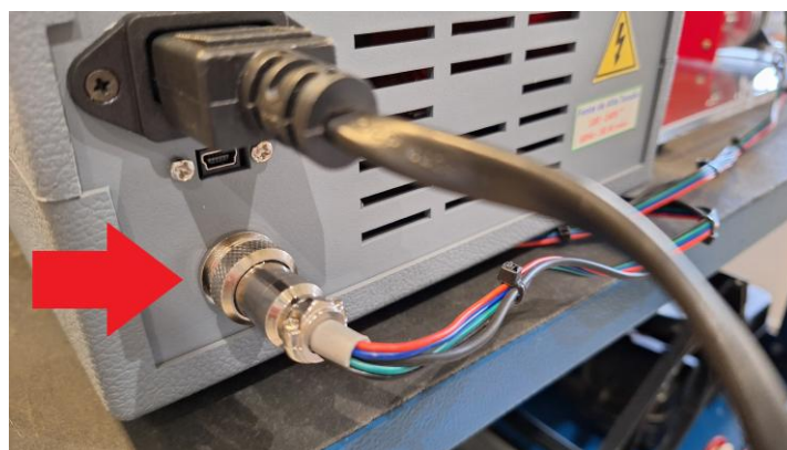
Figura 6 – Conector multipolo do cabo de ligação que conecta a unidade mecânica à unidade de controle
