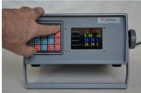
Pressionando “A” para voltar à tela de ajuste de tensão
