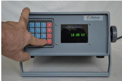
Se um valor maior do que “3” é digitado na primeira posição (primeiro dígito) este é automaticamente convertido para “3” pois a máxima tensão que pode ser gerada é de 30 kV. Da mesma forma, se 3 é o primeiro dígito, somente “0” será registrado nos dígitos subsequentes.
