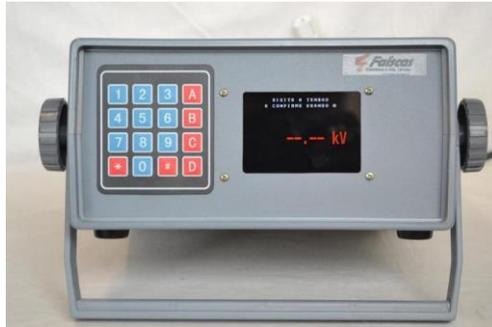
O display apresenta “**---.---kV**” e assim permanece até que um valor seja digitado. Por exemplo, para gerar 10 kV a sequencia de teclas pressionadas deve ser “1”, “0”, “0”, “0” e por fim o valor confirmado apertando “#” como na sequencia nas fotos abaixo. Observe que à medida que os numero vão sendo introduzidos os dígitos correspondentes trocam de cor vermelha para verde, e quando o valor é confirmado troca de cor a indicação “kV”, informando desta maneira que o valor foi aceito.
