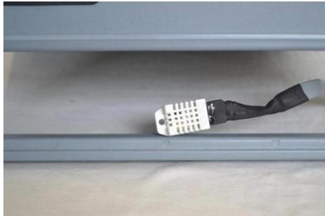
Detalhe do sensor de umidade e temperatura
