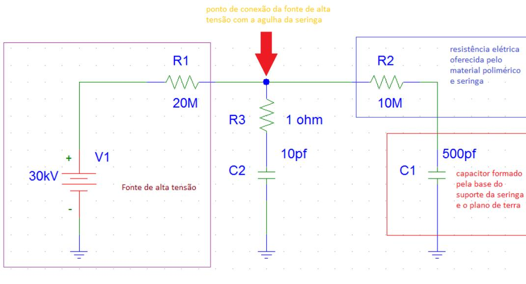
Figura 2 – circuito elétrico equivalente à figura 1
