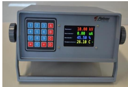
Figura 3 – fonte de alimentação com limitação de corrente de saída
