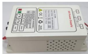
Figura 5 – fonte de alimentação não estabilizada para uso em filtros eletrostáticos
